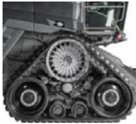
Le train de chenilles TrakRide garantit une pression au sol extrêmement faible.
