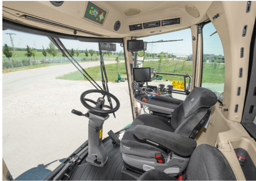
La cabine Visio5 est conçue pour optimiser la visibilité et offre une ergonomie et un fonctionnement parfaits sur l'environnement de travail. Grâce à la forme spéciale du contour du toit, la goulotte est toujours dans le champ de vision du conducteur. L'environnement de travail reste agréable grâce à la climatisation et au chauffage automatique.
