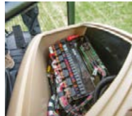
■ Diagnose-aansluitingen voor FENDIAS in de goed bereikbare zekeringenkast
