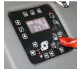
■ Met behulp van OptiFlow-bedieningscentrum en vultrechter worden tijdens het vullen alle meng- en vulfuncties comfortabel bediend.
