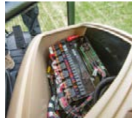
■ Système électrique central facilement accessible avec les prises de diagnostic FENDIAS.
