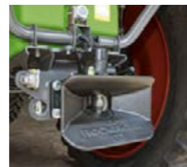
□ Attelage automatique avec frein et connexions électriques.
