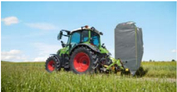
Vanuit de cabine is de machine gemakkelijk van werkstand in de zeer compacte transportstand te zetten, en omgekeerd.
