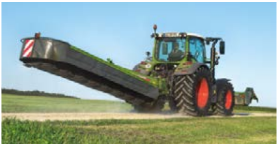
In transportstand wordt de maaier vanuit de cabine 90 graden naar achteren gezwenkt.
