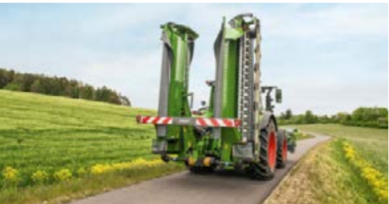
In opgeklapte toestand is de hoogte van de maaiercombinatie nog steeds minder dan 4 meter. Ook zorgt het lage zwaartepunt voor een comfortabel weggedrag.
