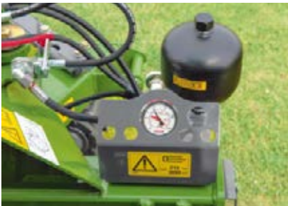
De hydropneumatische TurboLift-maaibalkontlasting maakt de unieke 'zwevende snede' mogelijk.
