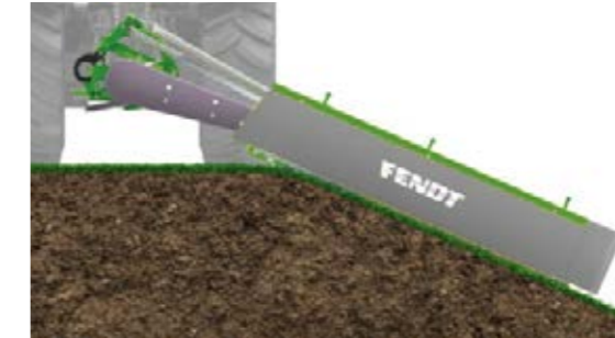
Faucher les fossés et les pentes jusqu'à 30°.
