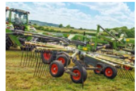
Lors de la descente en bout de champ, ce sont les roues arrière qui entrent en premier en contact avec le sol, puis celles avant. Lors du levage, les toupies sont soulevées à l'avant en premier. Cet effet Jet protège le tapis végétal.
