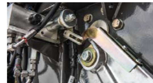
Le contrôle de position du timon permet de maintenir et régler automatiquement l'angle d'ouverture réglé du pick-up. Avec, pour résultat, un flux de récolte constant sans aucun goulot d'étranglement, et d'excellentes performances de ramassage même sur terrain vallonné.
