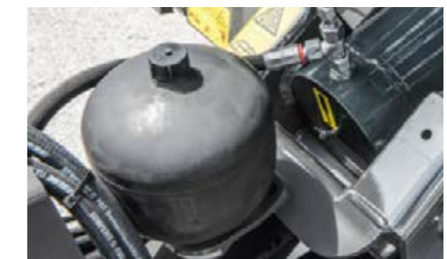
La suspension du timon de la Fendt Tigo améliore encore le confort de conduite.
