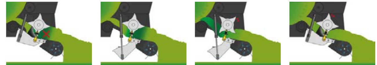
En cas de blocage éventuel, la partie arrière du fond de rotor est abaissée de 500 mm.
