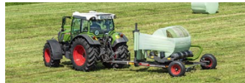
De Fendt Rollector wikkelt balen met diameters van 0,90 tot 1,30 meter.
