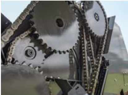
De aandrijving van de kamer vindt verdeeld over twee kettingen plaats.
