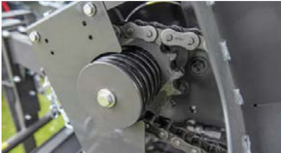
Het vrijlooptandwiel beschermt de aandrijving tegen schade in het geval de rotor geblokkeerd raakt.
