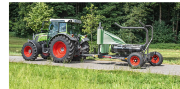
Pratique : Vous pouvez stocker jusqu'à trois rouleaux de films sur la Rollector 130.
