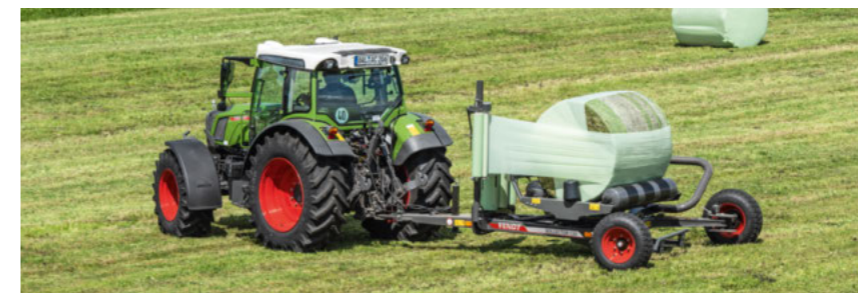
La Fendt Rollector enrubanne des balles de 0,90 m à 1,30 m de diamètre.
