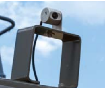
Le terminal est pré-câblé et doté d'un port caméra de série. Vous pouvez ainsi installer une caméra en sortie du canal de pressage afin d'avoir une excellente visibilité sur l'arrière de la presse.
