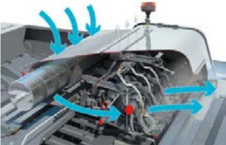
Le système de ventilation transversal fait partie de l'équipement standard, il permet de maintenir un flux d'air constant sur toute la zone des noueurs permettant ainsi un parfait nettoyage de ces derniers.
