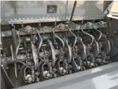
Les doubles-nœuds éprouvés des presses à balles carrées Fendt garantissent un liage fiable, même avec une pression de compression élevée.
