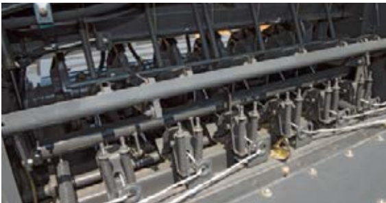
La ficelle est guidée par les freins du noueur, pour un chargement homogène de la ficelle dans le noueur.
