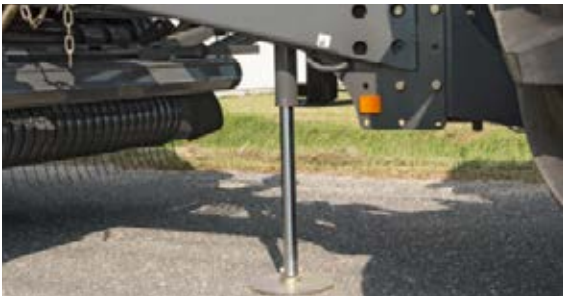
La béquille de stationnement hydraulique en option facilite les opérations d'attelage et de dételage du tracteur.
