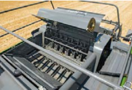
Un grand capot de maintenance et un ventilateur à turbine transversal escamotable garantissent un accès aisé aux noueurs.
