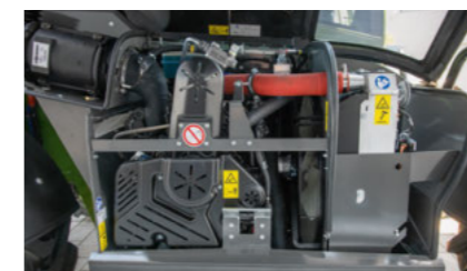
Koeling – Opties • Omkeerbare koelventilator • Automatisch activeren in 3 intervallen (20, 40 of 60 minuten) of manuele activering via knop.
