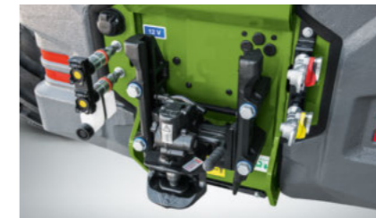
• Automatische trekhaak (Rockinger) • Max. aanhangerbelasting 18,5 t
