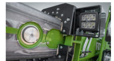
Vuilschraper • Verhindert het binnendringen van vuil in het binnenste van de telescopische arm en beschadigen
