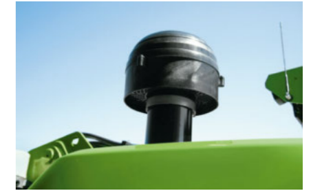
• Cycloonvoorscheider voor de luchtfiler (afscheidingsgraad 98%)
