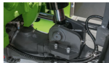
Chassis – Opties Pendelasblokkering voor de achteras • Functie 1: pendelt vrij • Functie 2: automatische activering bij stilstand • Functie 3: permanent geblokkeerd
