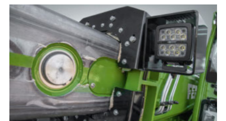
Racler • Diminue la pénétration de saleté à l'intérieur de la flèche télescopique et protège de l'usure prématurée et des dommages
