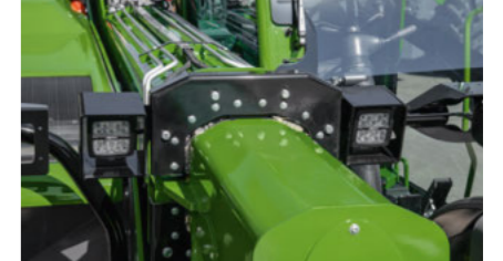
Eclairage LED sur bras de levage
