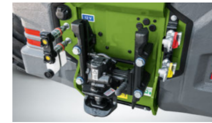
• Chappe d'attelage automatique de remorque (Rockinger) • Charge max. de la remorque 18,5 t
