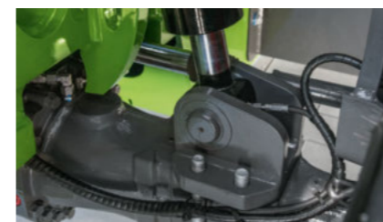
Châssis – Options Blocage de l'oscillation du pont arrière • Fonction 1 : oscillation libre • Fonction 2 : blocage automatique à l'arrêt • Fonction 3 : blocage permanent
