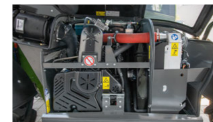
Refroidissement – Option • Ventilateur réversible • Activation automatique à 3 intervalles (20, 40 ou 60 min), ou déclenchement manuel par bouton-poussoir.
