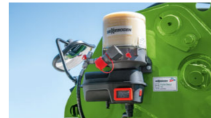
Graissage automatique centralisé • Alimentation de tous les points de graissage, y compris ceux du bras télescopique
