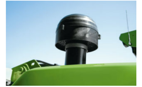
• Préséparateur cyclonique pour filtre à air (taux de séparation de 98 %)
