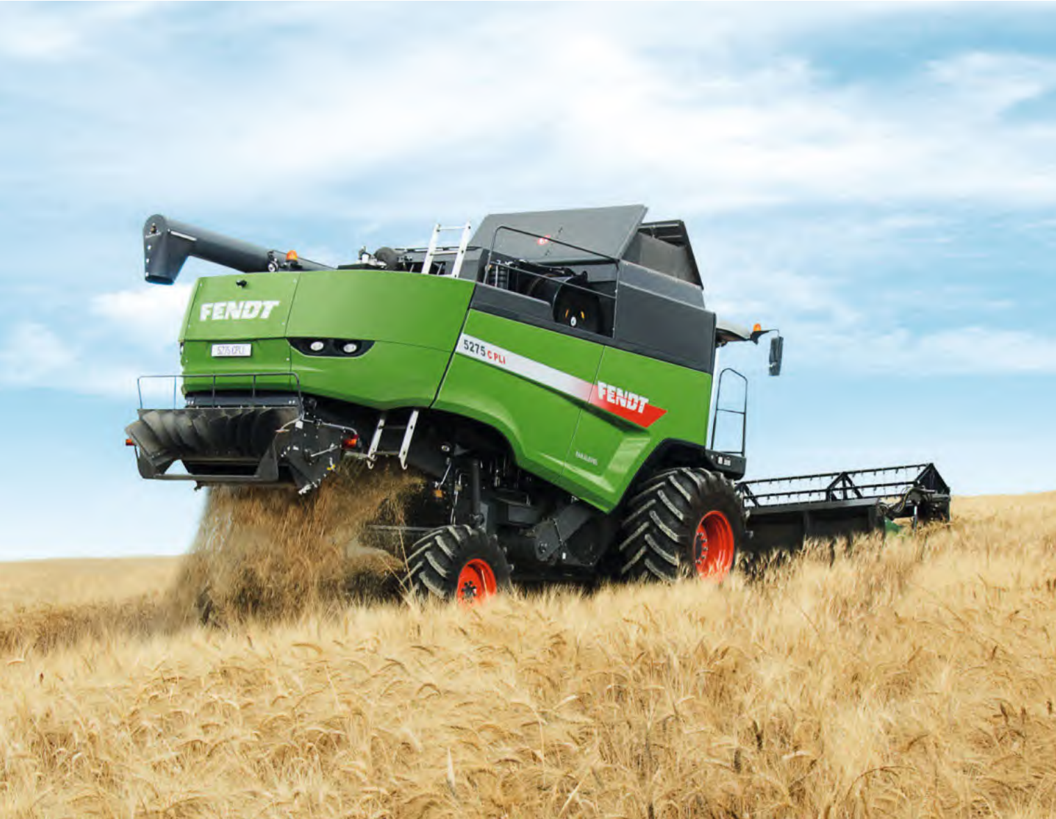
L'inclinaison longitudinale de la machine est compensée par 2 robustes vérins hydrauliques reliés au châssis du pont arrière séparé.
