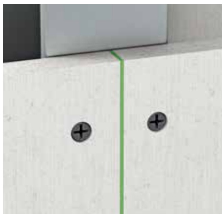
fermacell lijmvoeg – voegbreedte: 0.5 - 1 mm
