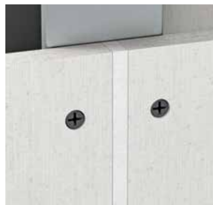
fermacell gipsvoeg – voegbreedte: \frac{1}{2} \times plaatdikte
