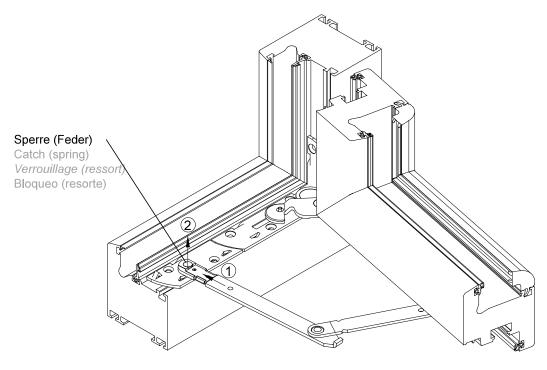
Flügel 85° öffnen, Sperre (Feder) leicht anheben, Drehbegrenzer in Richtung Blendrahmen schieben und aus dem Zapfen an der Rahmenplatte aushängen.
