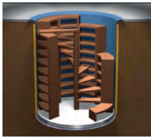
Opvulling van de randen met zand. Sand backfilling.
