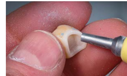
Sandblast LiSi Press-units met Al 2 O 3 (50 µm, 0,2 MPa) om alle potentiële verontreinigingen te verwijderen.
