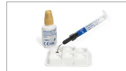
30. Voor het extern karakteriseren met de GRADIA®Lustre Paints is het noodzakelijk deze altijd te verdunnen met de aangewezen Lustre Paint Diluting Liquid. Door het verdunnen kan een lichter chroma verkregen worden.
