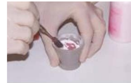
Verhouding van 1 schep poeder & 2 eenheden vloeistof: mix voor 30-60sec
