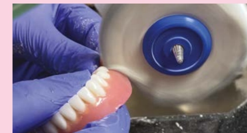
Polijsten met puimsteen en op hoogglans brengen met diamantpasta..
