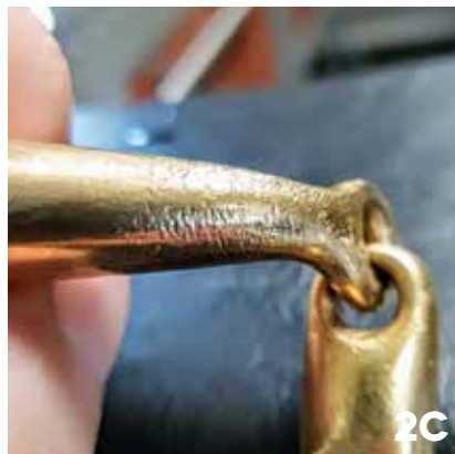
Figure 2c et d : Usure due au « mordillement » du mors.
