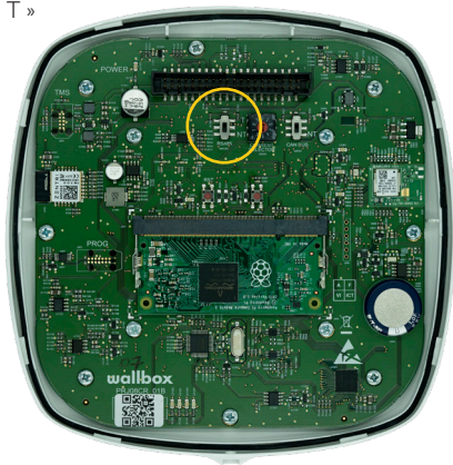
Figure A3.1 Réglage du commutateur RS485 sur « T »
