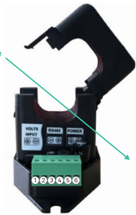
Fig. A21: diagrama de ligação do contador de potência
