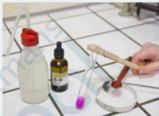
Bij het toevoegen van \text{Na}_2\text{O} bij water kleurt de fenolftaleïne magenta. Dit wijst op de vorming van een hydroxide.
