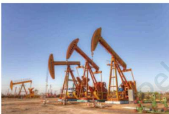
Jaknikkers pompen olie uit de grond.
