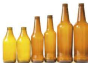
Bruine flessen (toevoeging van \text{Fe}_2\text{O}_3 )
