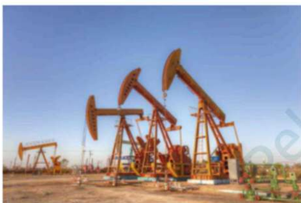
Jaknikkers pompen olie uit de grond.
