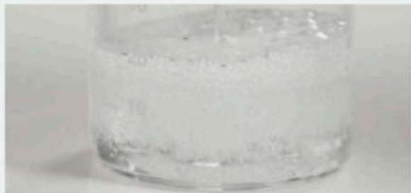
Gasontwikkeling bij de reactie van een \text{Na}_2\text{CO}_3 -oplossing met een \text{HCl} -oplossing
