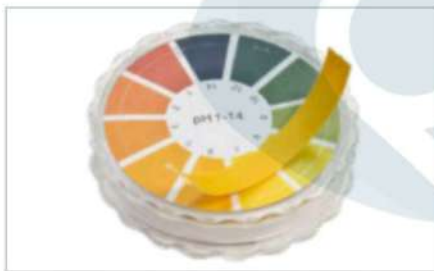
Universele indicatoroplossing of -strookje doordrenkt met universele indicatoroplossing
