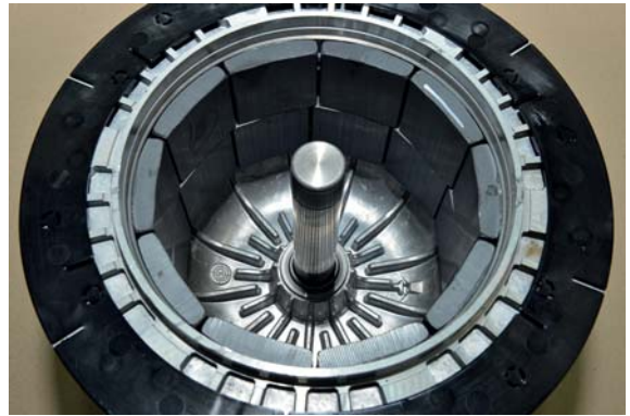
Aluminiumdruckgussrotor mit Kunststoffscheibe (nicht dargestellt) am Bund
