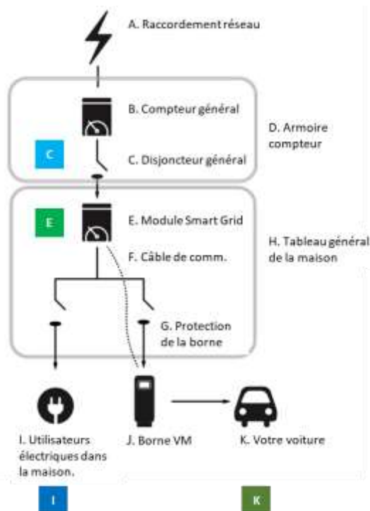
Figure 1: Installation domestique électrique avec VM Mobility Pack
