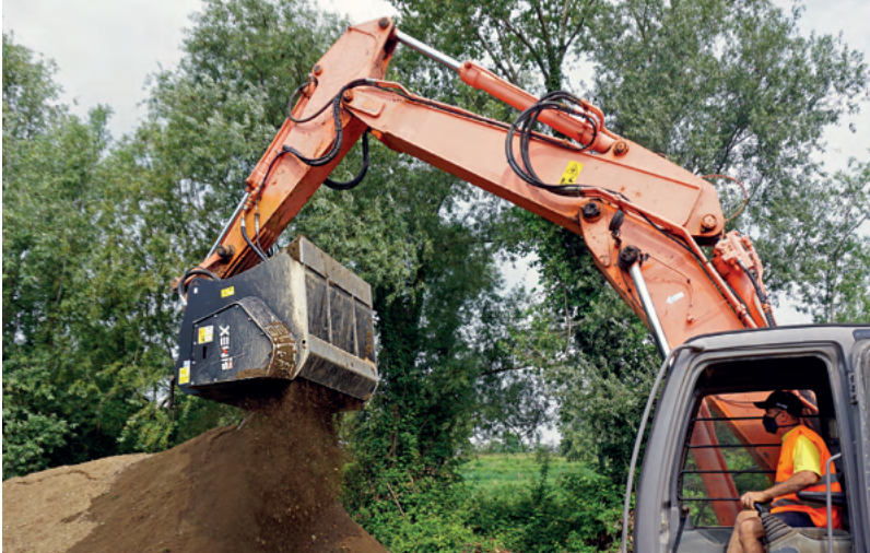
VSE 30. Aération et criblage de la terre végétale pour revente dans le domaine horticole.
