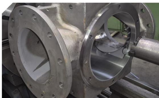
Boringen van doseersluizen
