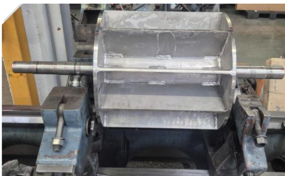
Rotoren van doseersluizen
