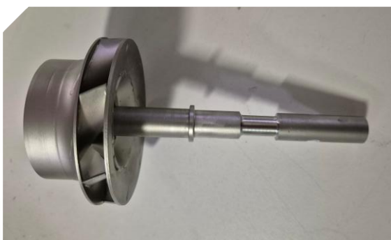
Rotoren van centrifugaalpomp
