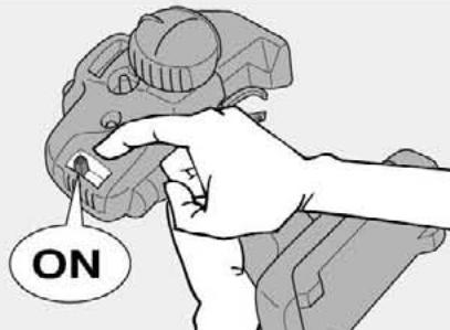
① スイッチをONにします。アンテナ付き送信機の場合はアンテナをのばしてください。
