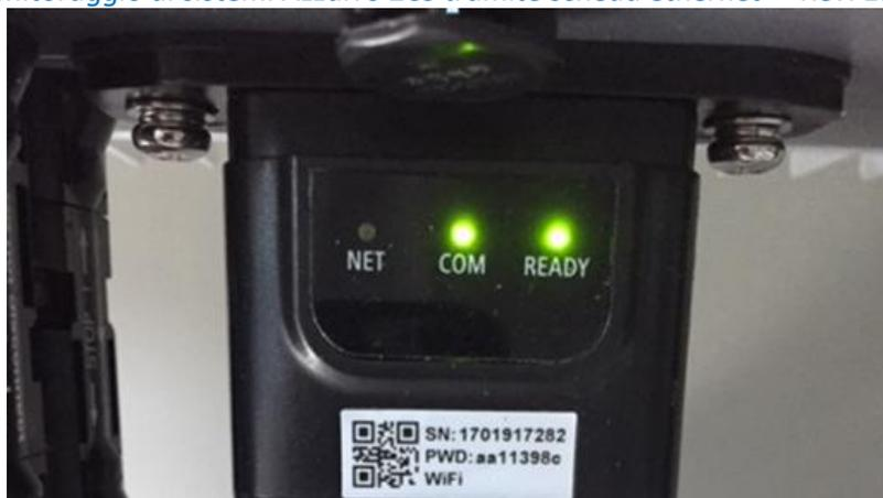
Figura 6 – Stato iniziale dei led
