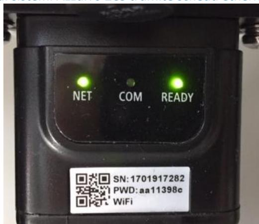
Figura 8 - Stato di comunicazione irregolare tra inverter e scheda
