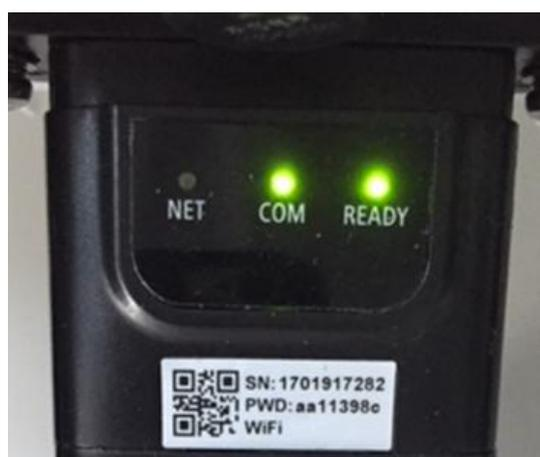
Figura 9 – Stato di comunicazione irregolare tra scheda e server remoto
