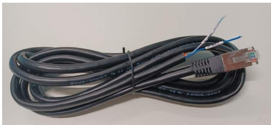
Figura 8 - Cavo di comunicazione Pylontech da inserire nell'ingresso di comunicazione della batteria
