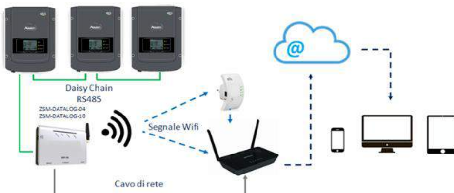
Figura 93 – Schema per il collegamento del datalogger ZSM-DATALOG-04 / ZSM-DATALOG-10
