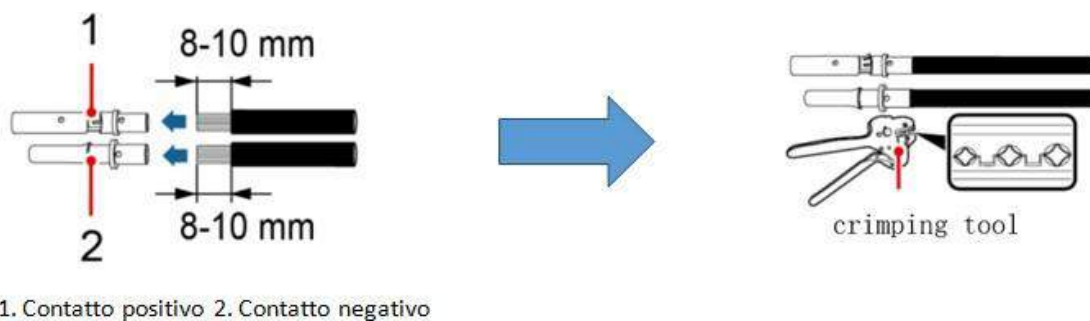
Figura 41 – Preparazione dei cavi fotovoltaici positivo e negativo
