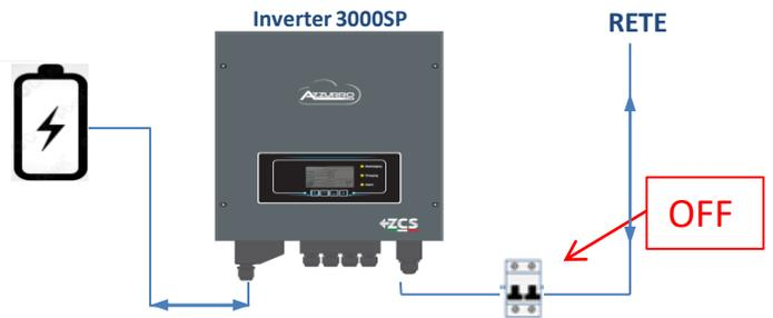
Assicurarsi che non ci sia produzione da parte dell'impianto fotovoltaico sulla fase in cui è collegato il 3000SP, aprire quindi l'interruttore di protezione AC dedicato all'inverter fotovoltaico in modo di essere certi che non sia in produzione.
