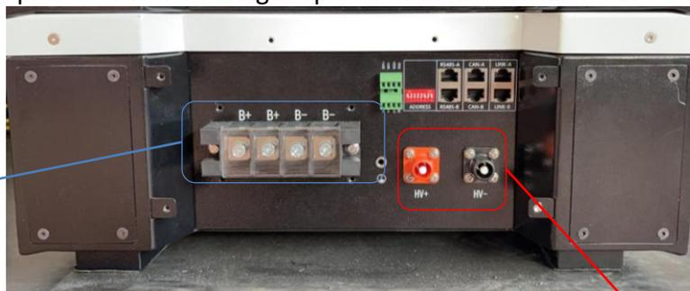
**Attenzione:** Per il collegamento delle batterie 5k3 con inverter inverter monofase è obbligatorio utilizzare la sola sezione in bassa tensione. Non utilizzare la sezione in alta tensione onde evitare danneggiamenti di batterie o inverter
