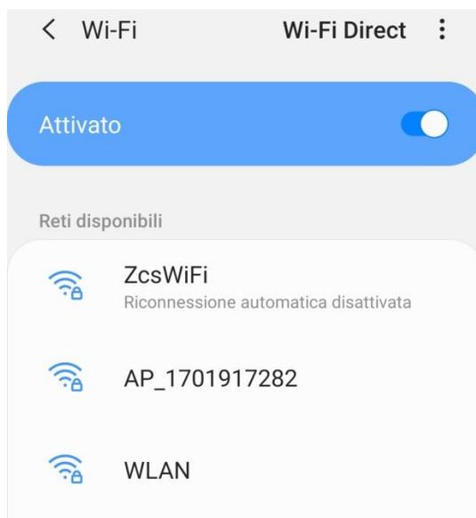
Figura 7 - Disattivazione della riconnessione automatica ad una rete
