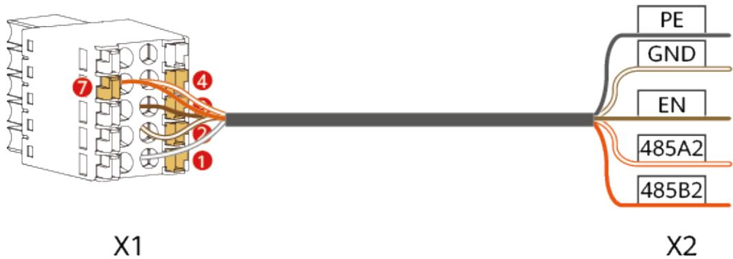
**Tabella 6-2** Collegamento del cavo di segnale (acquistato dal fornitore, tipo 1) tra la batteria e l'inverter
