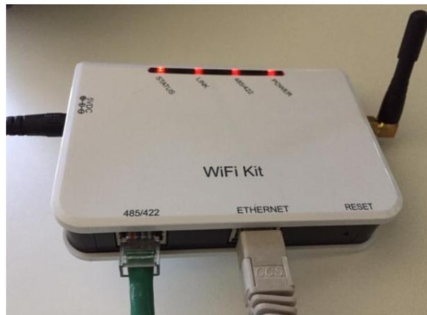
Figura 7 - Cavo ethernet connesso al datalogger
