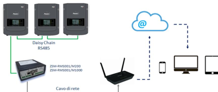
Figura 2 - Schema di funzionamento del datalogger ZSM-RMS001/M200 / ZSM-RMS001/M1000
