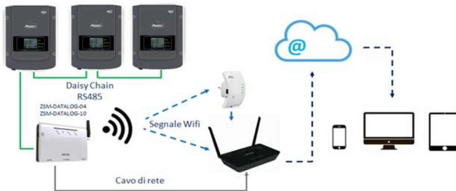
Figura 1 - Schema di connessione del datalogger ZSM-DATALOG-04 / ZSM-DATALOG-10
