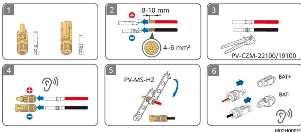
In un sistema parallelo, collegare i cavi di alimentazione CC tra gli ESS facendo riferimento ai collegamenti dei cavi tra l'inverter e un ESS.
