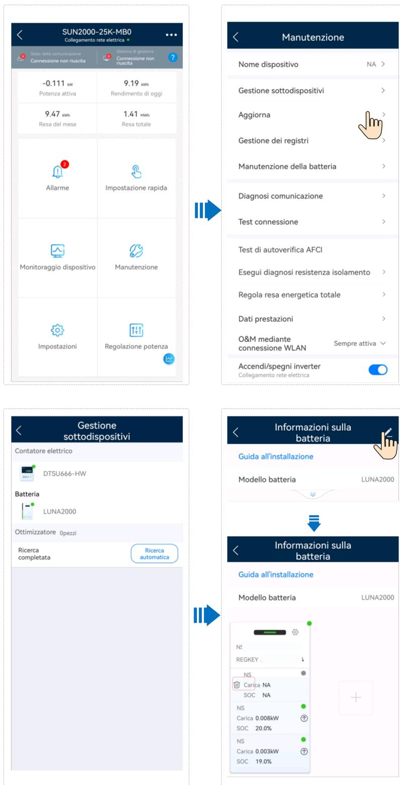
Quando EMMA viene utilizzata per il collegamento in rete, **collegare EMMA all'app**, toccare **Monitoraggio dispositivo** nella schermata Home, selezionare l'inverter collegato, scegliere **Manutenzione > Gestione sottodispositivi**, toccare l'icona ESS ed eliminare il modulo di accumulo di energia offline.
