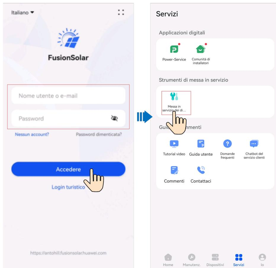
**Passaggio 2** Connettersi alla WLAN dell'inverter, accedere come **Installatore** e accedere alla schermata della messa in servizio del dispositivo.
