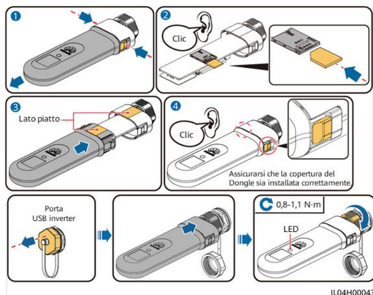
**Figura 5-48** Installazione dei componenti antifurto per lo Smart Dongle
