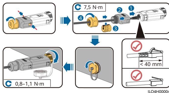
**Figura 5-46** Installazione dei componenti antifurto per lo Smart Dongle
