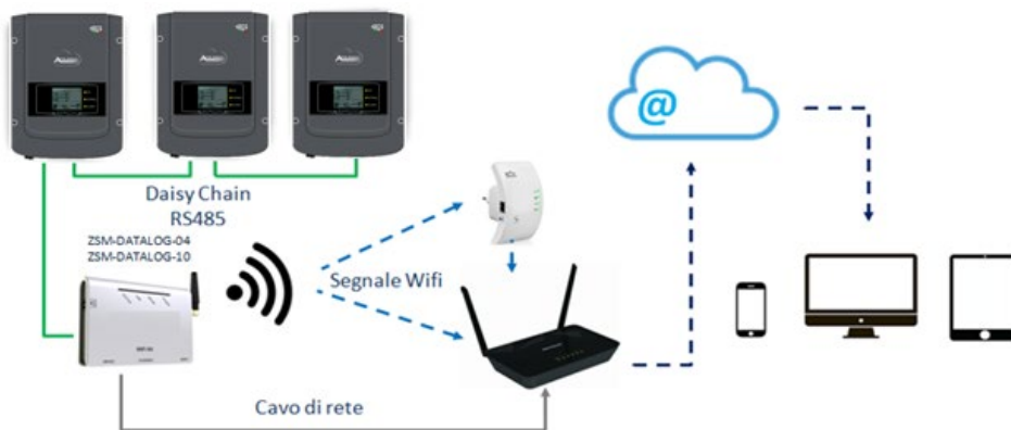
Figura 141 – Schema di connessione del datalogger ZSM-DATALOG-04 / ZSM-DATALOG-10
