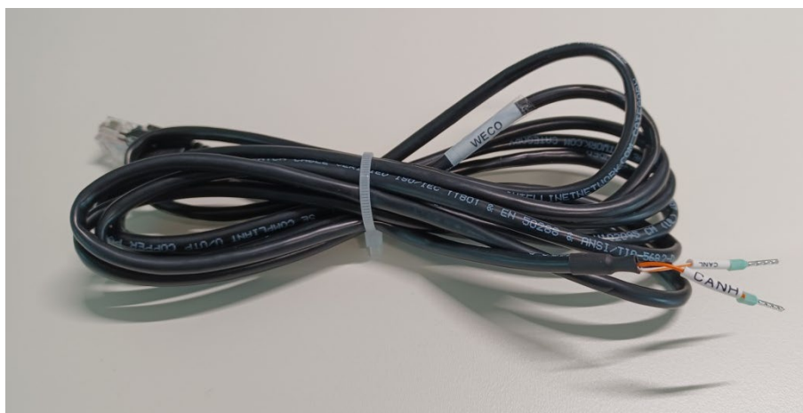
Figura 53 - Cavo di comunicazione tra l'inverter e la batteria WeCo 5K3XP
