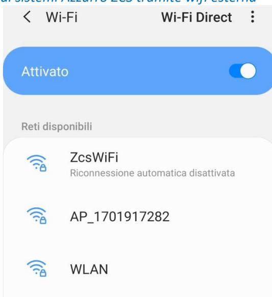
Figura 5 – Disattivazione della riconnessione automatica ad una rete
