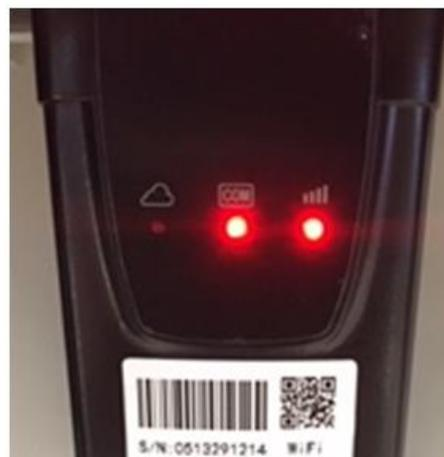
Figura 19 – Stato iniziale dei led
