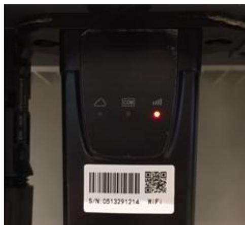
Figura 24 – Stato di comunicazione irregolare tra wifi e server remoto
