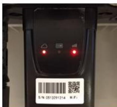
Figura 22 - Stato di comunicazione irregolare tra inverter e wifi
