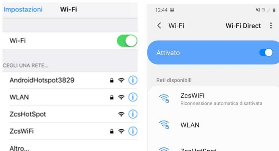
Figura 17 - Ricerca delle reti wifi su Smartphone (iOs e Android); l'Access Point della scheda wifi non è più visibile
