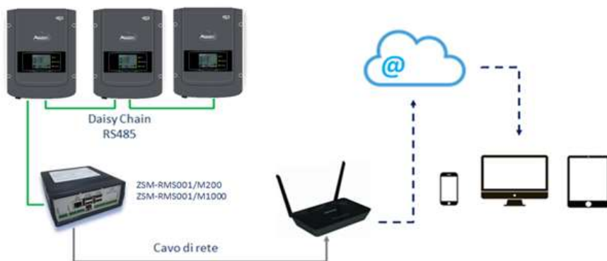
Figura 125 – Schema di funzionamento del datalogger ZSM-RMS001/M200 / ZSM-RMS001/M1000
