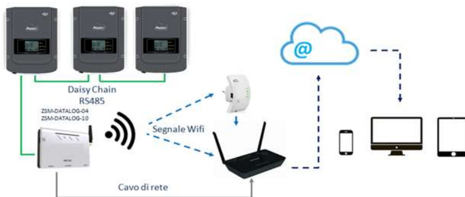
Figura 124 – Schema di connessione del datalogger ZSM-DATALOG-04 / ZSM-DATALOG-10
