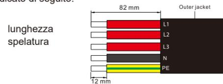
2. Svitare il dado di fissaggio del coperchio impermeabile AC e rimuovere gli anelli di tenuta. Selezionare un numero adeguato di anelli di tenuta in base al diametro esterno del cavo. Far passare il cavo in sequenza attraverso il dado di fissaggio, l'anello o gli anelli di tenuta e il coperchio impermeabile.
