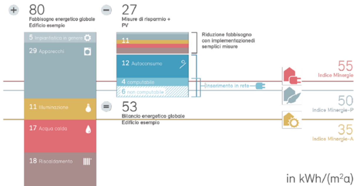
Figura 2: Esempio di bilancio e indice Minergie per una casa plurifamiliare, con i requisiti dell'indice Minergie per lo standard Minergie e Minergie-P. I valori standard richiesti sommati, sono confrontati con i risparmi conseguiti grazie a misure di efficientamento relative ai singoli fabbisogni e alla produzione energetica di impianti fotovoltaici. Tutti i valori di energia finale sono ponderati mediante i fattori di ponderazione nazionali.
