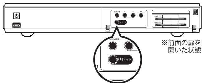
※ 本機の電源がオンのときに[リセット]ボタンを押すと、リセット後に再び電源がオンになります。
