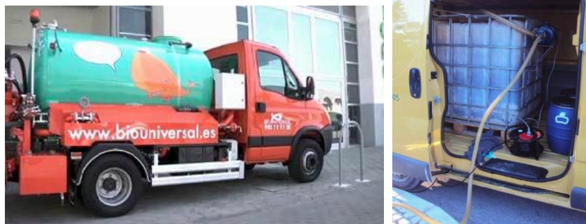
Figura 7-20 Tipuri de camioane și furgonete pentru transportul uleiurilor uzate din punctele de colectare
