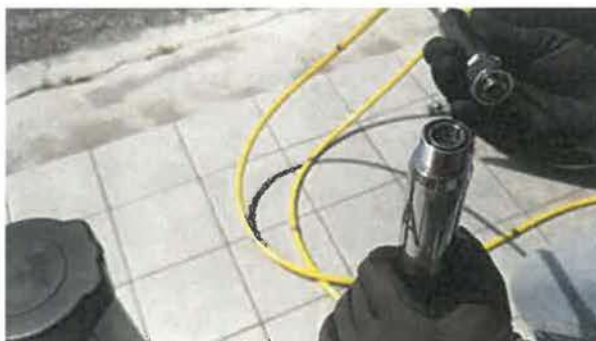
Fig. 16 Marcajul A+ de pe proba inclinometrică și conexiunea la cablul de date
