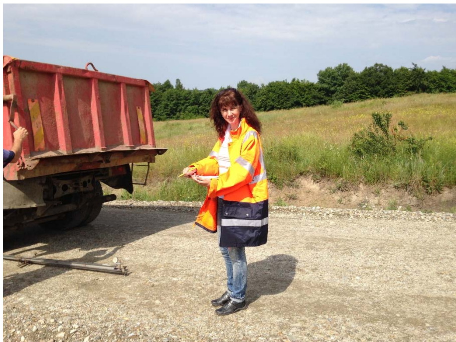
Figura 3: Măsurători cu grinda Benkelman : DC104 Vișinelu – Jud. Mureș
