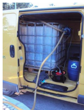
Figura 7-20 Tipuri de camioane și furgonete pentru transportul uleiurilor uzate din punctele de colectare
