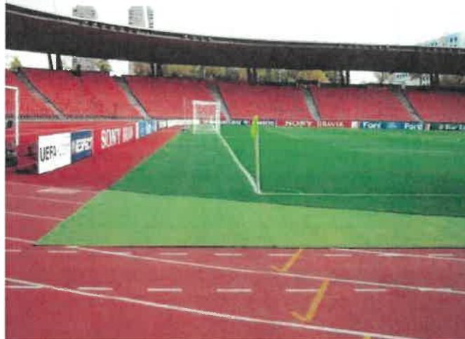
Prelungirea perimetrului gazonului din jurul terenului de joc utilizând gazon artificial de înaltă calitate (Fig. 27 - Ghidul UEFA privind calitatea terenului - Întreținerea terenului cu gazon natural – ediția 2018, p. 37)
