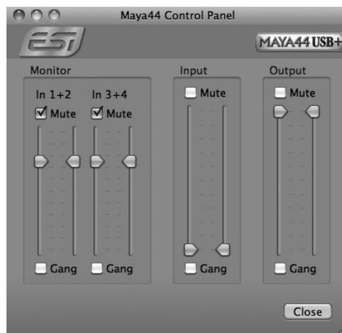
コントロールパネルのフェーダーで、入力モニターレベル、入力レベル、出力レベルを操作します。
